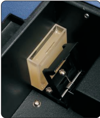
透射样品 透射测量:采用d:0°结构(漫射照明、 0°方向接收),符合ISO、CIE、ASTM 和DIN标准。
