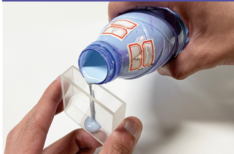
1、将测量粘稠状样品导入比色皿中。
